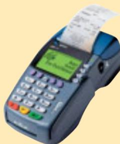
○ **ЭЛЕКТРОННЫЙ ТЕРМИНАЛ (POS-ТЕРМИНАЛ)** – это электронное устройство, работающее в режиме «он-лайн» с банковской системой. Проверка платежеспособности карты, получение разрешения на проведение операции, оформление чека и передача информации обо всех совершенных операциях производится автоматически.
